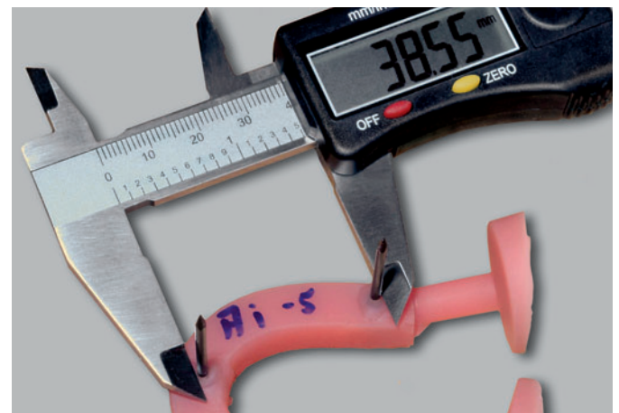
Abb. 10 und 11 Die in Kunststoff reproduzierten Prüfkörper werden in ihren Werten ebenso wie das Original vermessen, also die Abstände an den Spitzen der Stifte und an der Austrittsstelle des Kunststoffes. Anschließend werden diese Werte mit denen des Originals verglichen.
