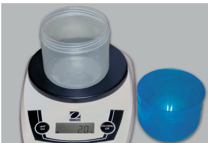
Abb. 12 Dosierbecher und Misch-, Anrühr- und Eingießbecher in einem geben dem Anwender richtig eingesetzt ein hohes Maß an Komfort beim Anrühren und Eingießen von Prothesenwerkstoffen.
